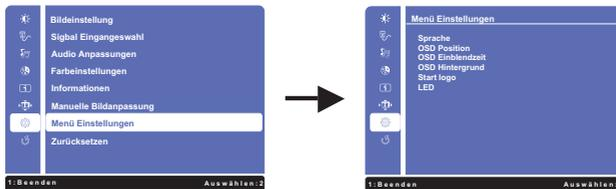
Eine Einstellungen erscheint nach dem Drücken der ② -Taste. Wählen Sie V. Position mit den Tasten ▲ / ▼. Drücken Sie erneut auf die ② -Taste. Verwenden Sie dann die Tasten ▲ / ▼, um die Einstellungen für die OSD vertikale Position zu ändern. Hierbei sollte die OSD vertikale Position der allgemeinen Anzeige ebenfalls entsprechend angepasst werden.
