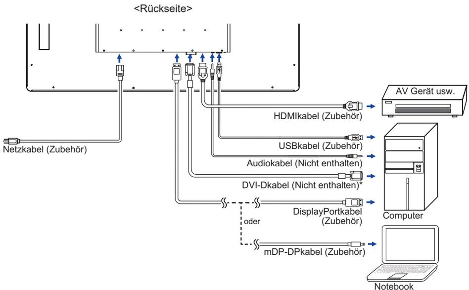
\* Das DVI-D-Kabel ist nicht im Lieferumfang enthalten. Wenn ein qualitativ niedriges DVI-D-Kabel verwendet wird, kann dies elektromagnetischen Störungen verursachen. Bitte kontaktieren Sie das iiyama Support Center in Ihrem Land, wenn Sie den Monitor über den DVI-Eingang anschließen wollen.
