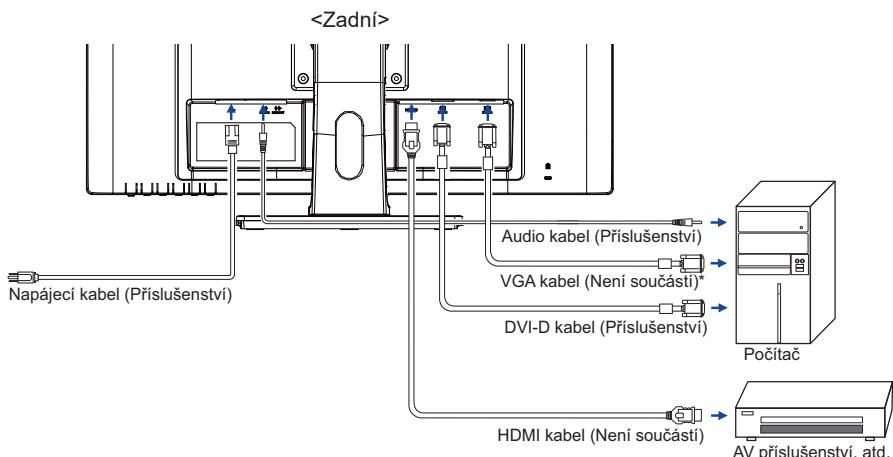
\* VGA kabel není součástí dodávky monitoru. Pokud používáte VGA kabel nízké kvality, může dojít k elektromagnetickému rušení. Obraťte se prosím na servisní středisko iiyama ve Vaší zemi, pokud se chcete připojit monitor přes VGA vstup.
