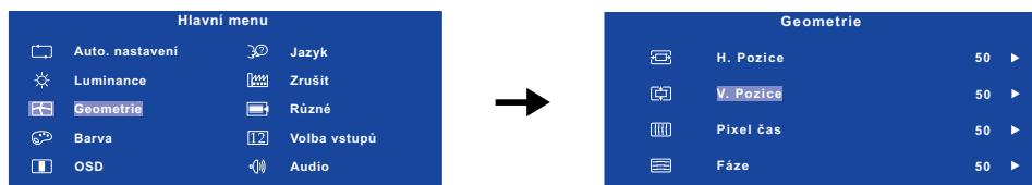
Potom pomocí tlačítka ▲ / ▼ pro změnu nastavení vertikální polohy. Vertikální poloha displeje by se měla odpovídajícím způsobem měnit, když děláte to.
