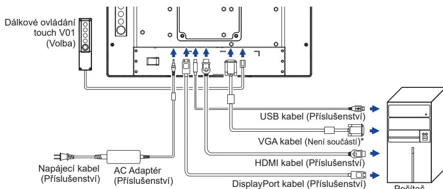
\* VGA kabel není součástí dodávky monitoru. Pokud používáte VGA kabel nízké kvality, může dojít k elektromagnetickému rušení. Obratě se prosím na servisní středisko iiyama ve Vaší zemi, pokud se chcete připojit monitor přes VGA vstup.
