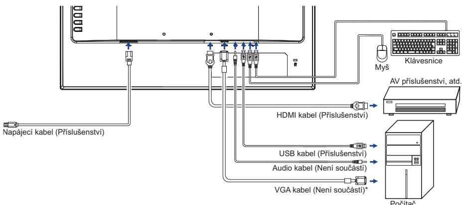
\* VGA kabel není součástí dodávky displej. Pokud používáte VGA kabel nízké kvality, může dojít k elektromagnetickému rušení. Obraťte se prosím na servisní středisko iiyama ve Vaší zemi, pokud se chcete připojit displej přes VGA vstup.
