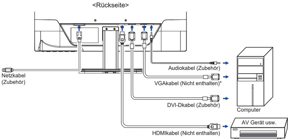
\* Das VGA Kabel ist nicht im Lieferumfang enthalten. Wenn ein qualitativ niedriges VGA Kabel verwendet wird, kann dieses elektromagnetischen Störungen verursachen. Bitte kontaktieren Sie das iiyama Support Center in Ihrem Land, wenn Sie den Monitor über den VGA-Eingang anschließen wollen.
